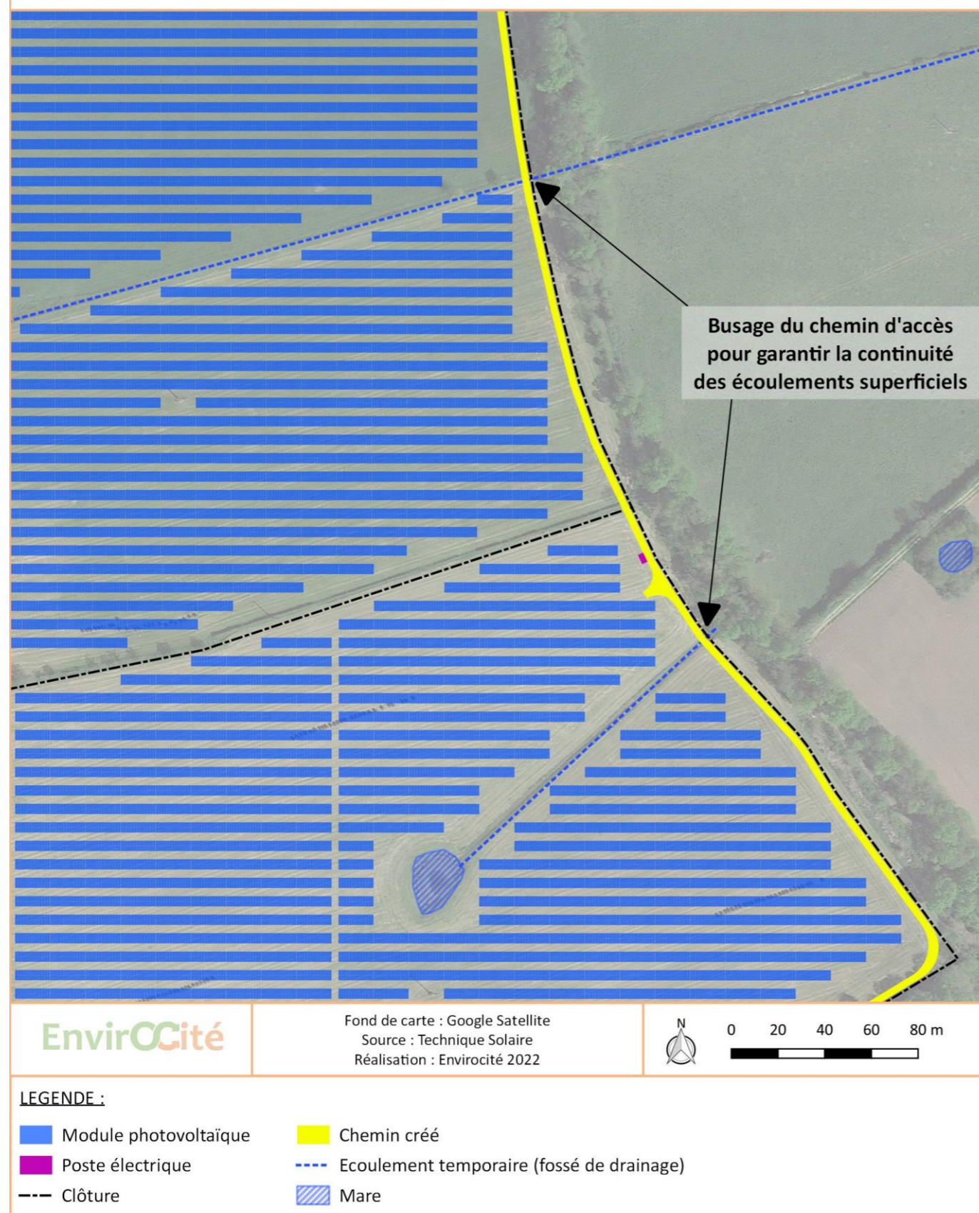
Carte 8 : le rétablissement de la continuité des écoulements d'eau par des busages
